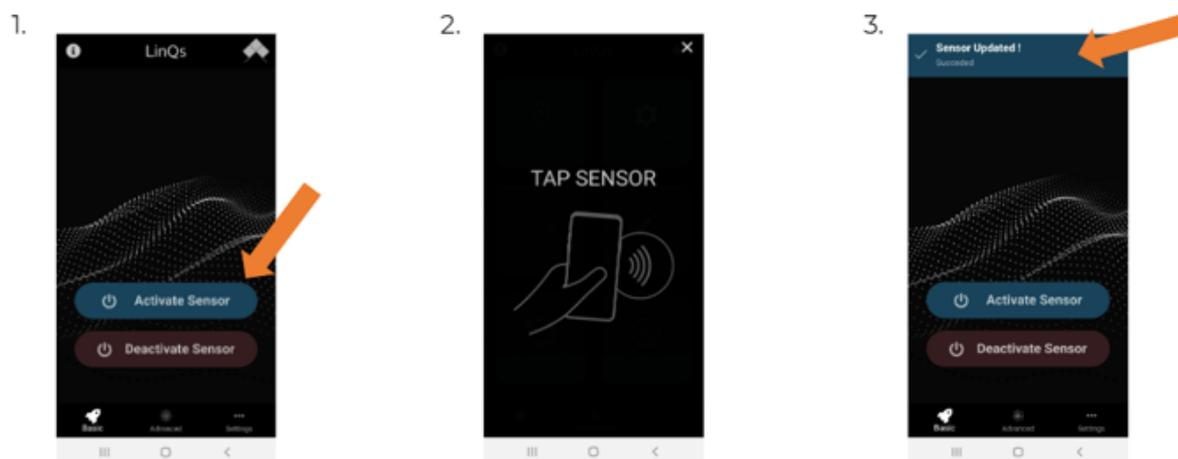
Wenn der Sensor aktiviert ist, wird "Sensor aktualisiert!" angezeigt. Danach können Sie mit der Aktivierung der anderen Sensoren fortfahren.
